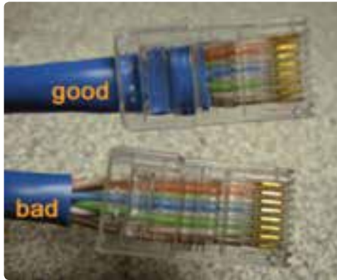
شکل ۴۸-۴- روکش برداری مناسب و نامناسب کابل‌های شبکه
