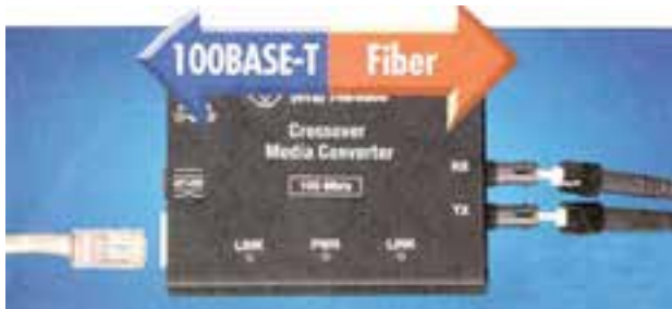
شکل ۱۷-۴- مبدل فیبر نوری به سوکت RJ45
