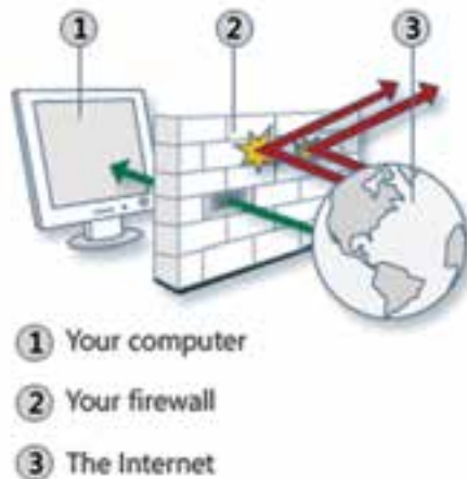
شکل ۷-۱- تصویر عملکرد دیواره آتش
