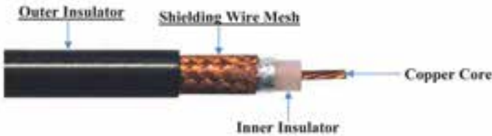
شکل ۲-۴ — کابل شبکه هم محور یا Coaxial
